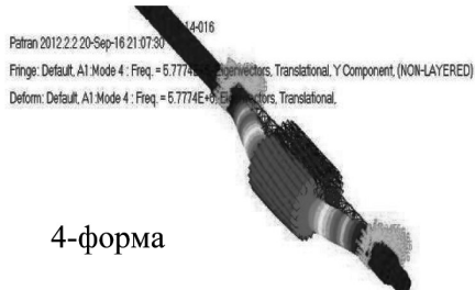
Рис. 4. Формы собственных колебаний приводного вала Fig. 4. Modes of natural vibration of gear shaft
